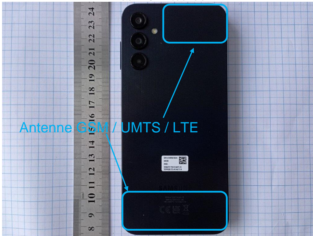
Photo 4: EST – vue arrière
