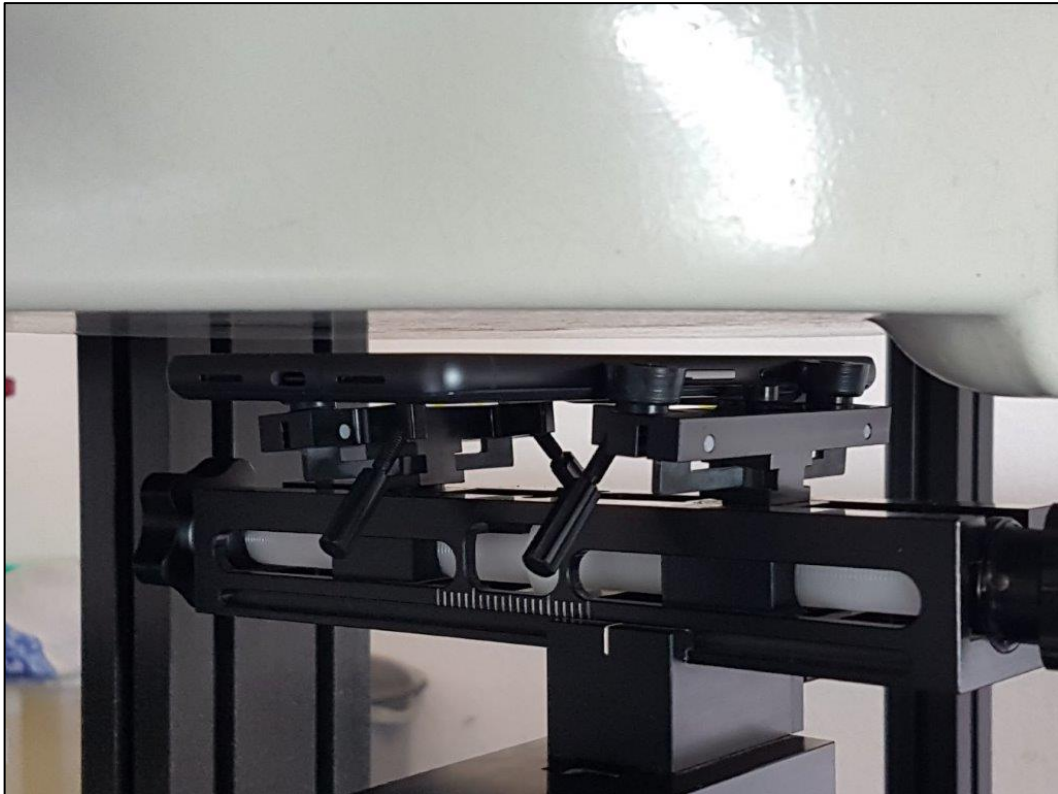
Photo 7: Position d'essai face arrière contre le corps (distance 5 mm)
