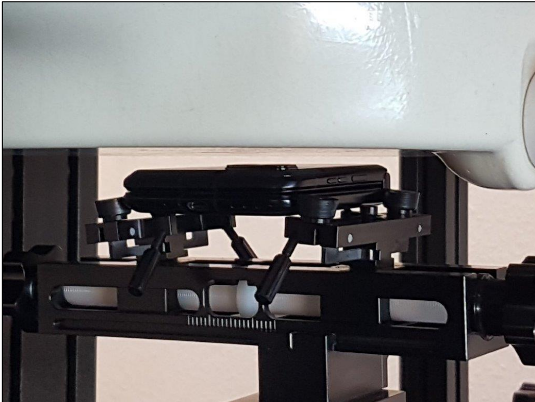
Photo 13: Position d'essai face Arrière pliée contre le corps (distance 5 mm)
