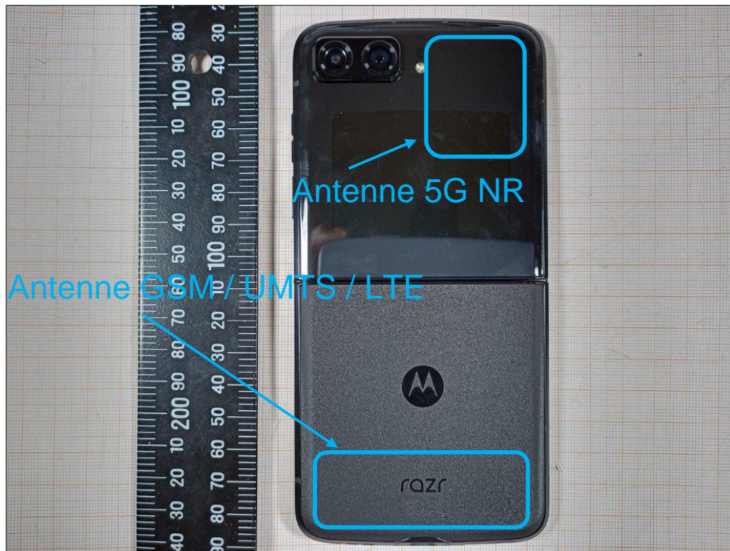
Photo 4: EST – vue arrière
