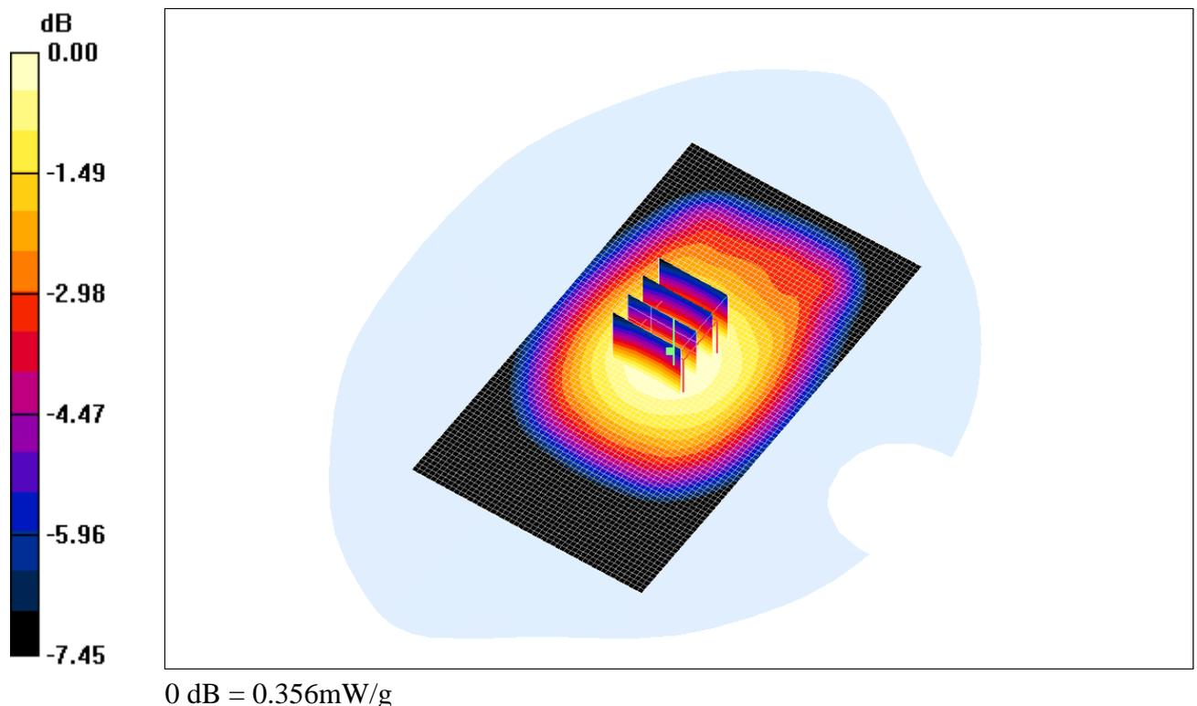
**Fig. 12 :** Distribution du DAS en LTE 800: canal 24250 (842.0 MHz) face arrière à 1.5cm du fantôme
