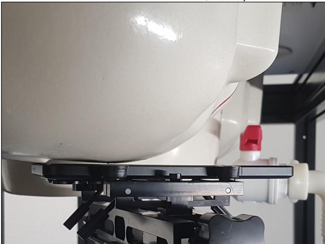
Photo 13: Position d'essai main droite, contre la joue
