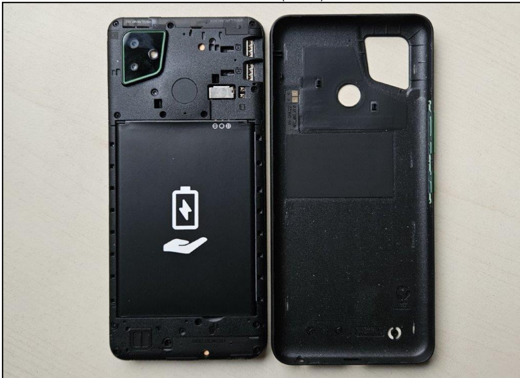
Photo 5: EST – vue arrière (ouvert) avec batterie
