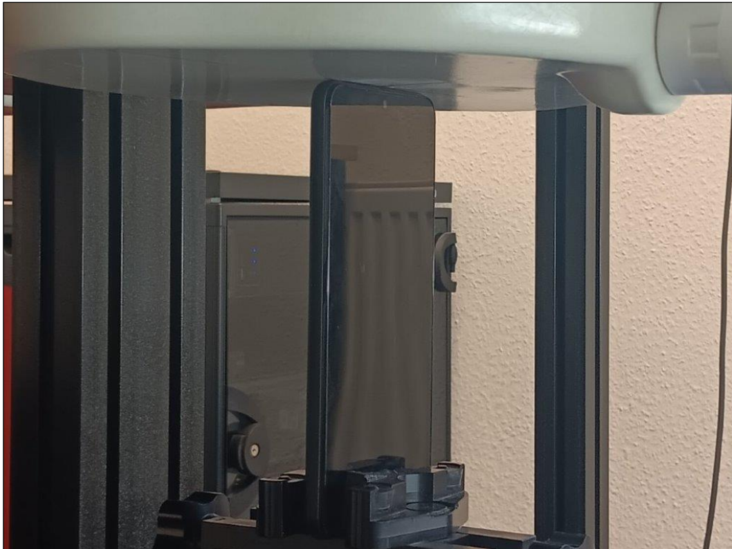
Photo 13: Position d'essai face du dessus contre le membre (distance 0 mm)
