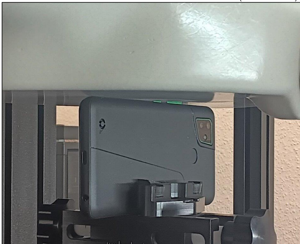
Photo 12: Position d'essai face du côté droite contre le membre (distance 0 mm)
