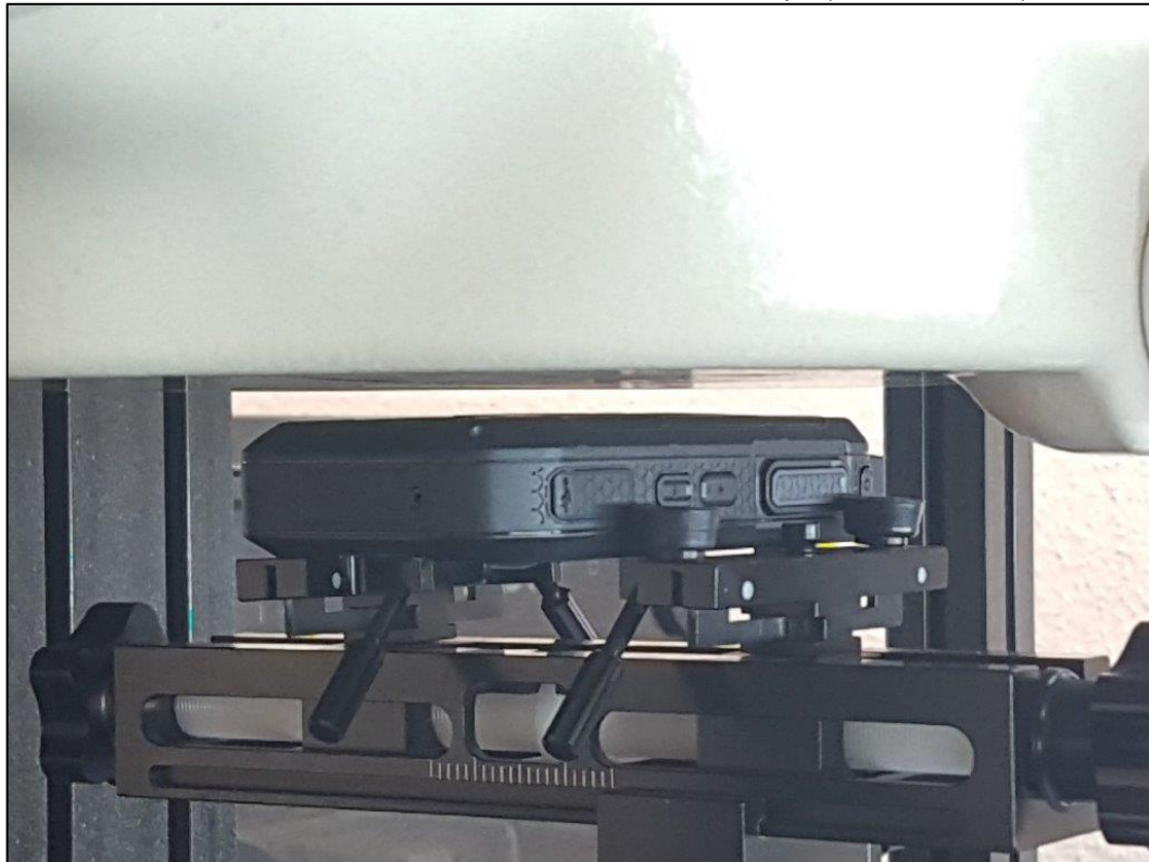
Photo 10: Position d'essai face arrière contre le corps (distance 5 mm)
