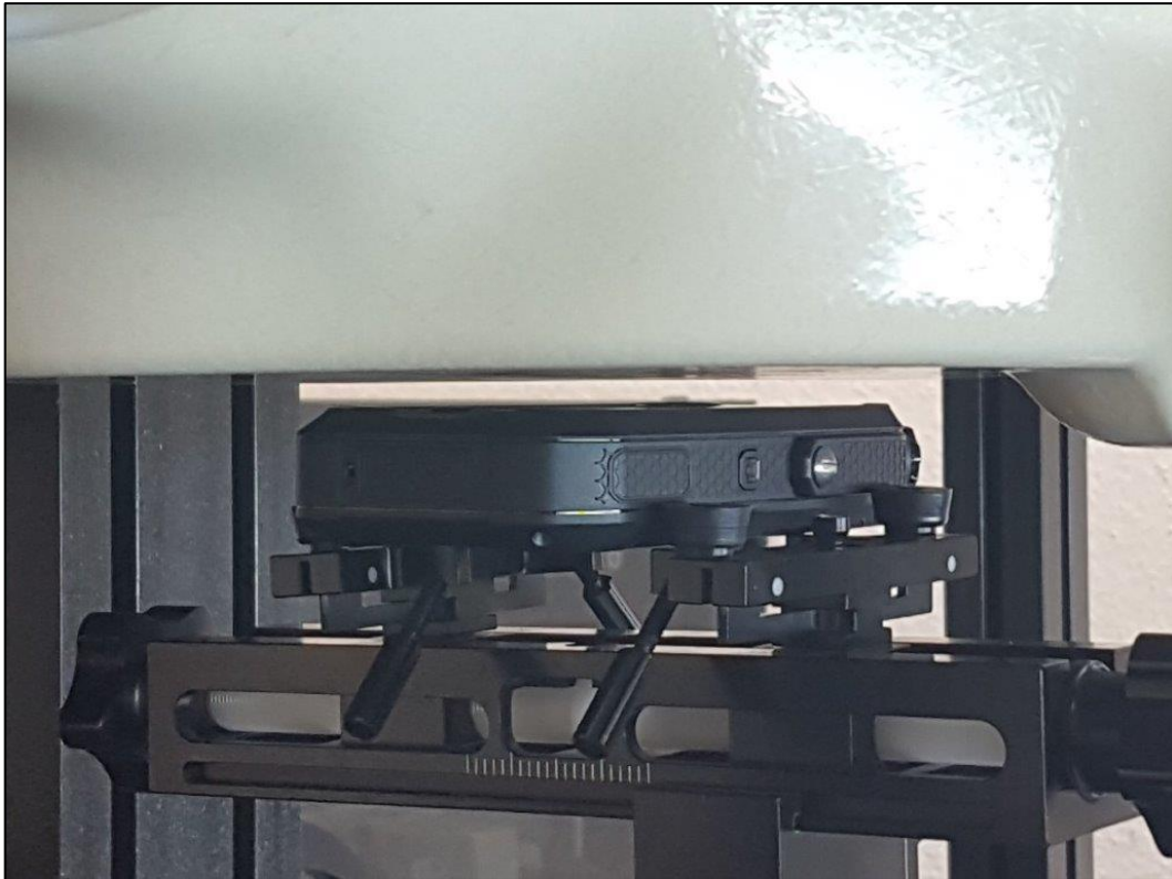
Photo 10: Position d'essai face arrière contre le corps (distance 5 mm)
