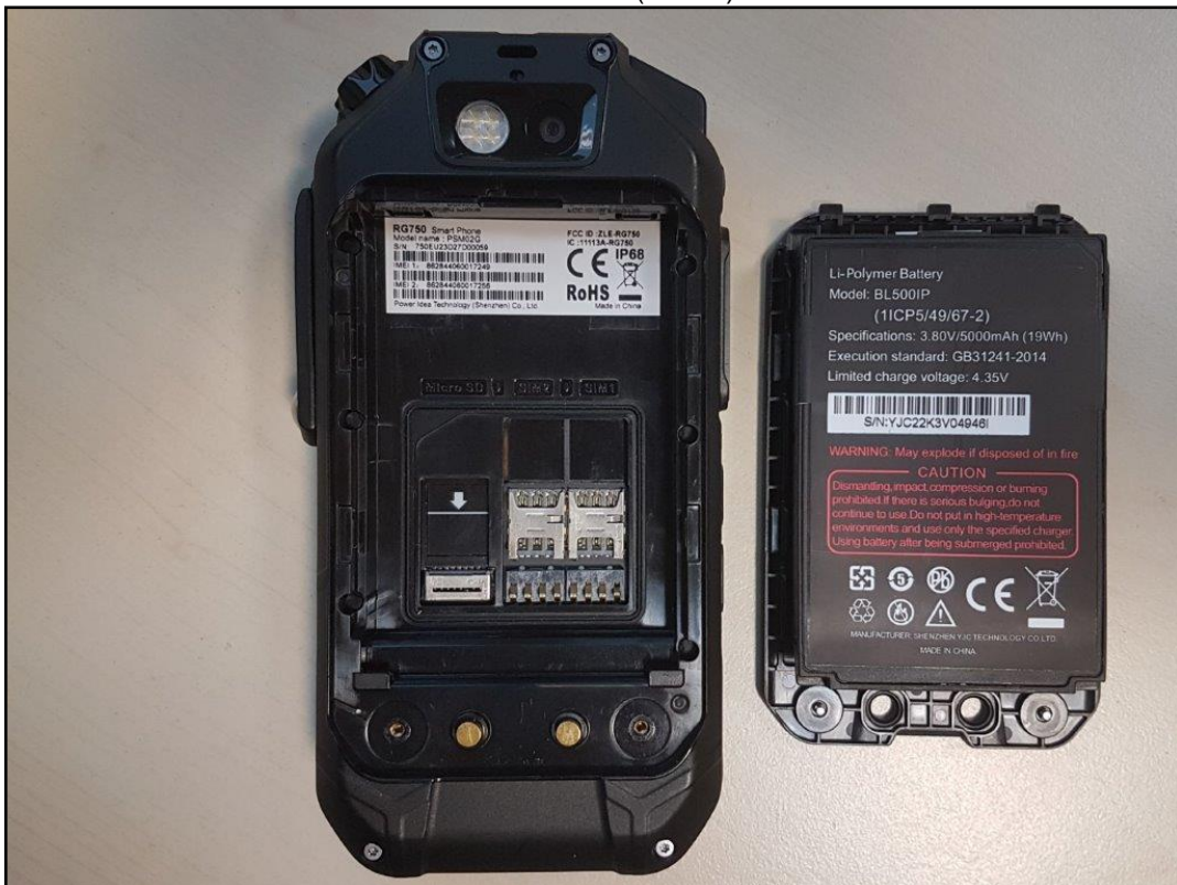
Photo 6: EST – vue arrière (ouvert) sans batterie
