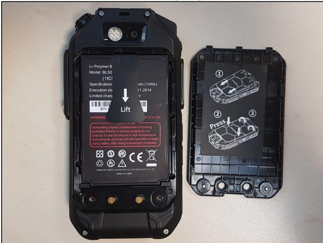
Photo 5: EST – vue arrière (ouvert) avec batterie
