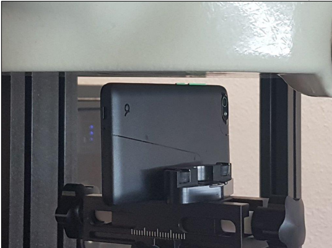
Photo 12: Position d'essai face du côté droite contre le corps (distance 5 mm)
