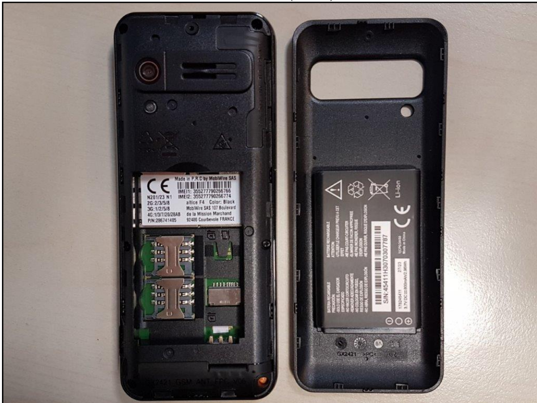
Photo 6: EST – vue arrière (ouvert) sans batterie
