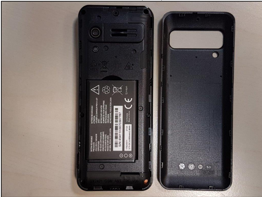
Photo 5: EST – vue arrière (ouvert) avec batterie
