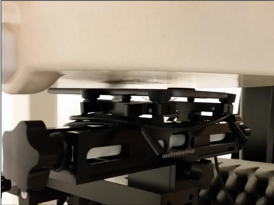
Photo 9: Position d'essai face arrière contre le corps (distance 5 mm) - sans couvercle-
