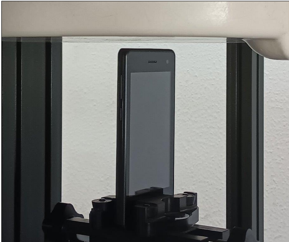
Photo 14: Position d'essai face du dessous contre le corps (distance 5 mm)
