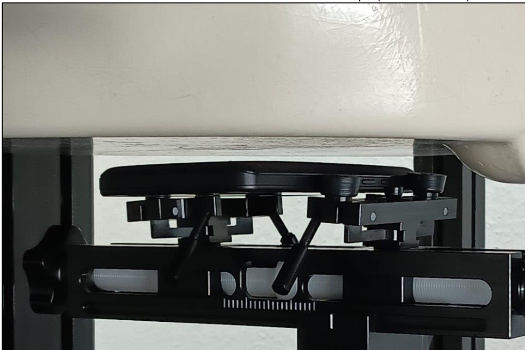
Photo 10: Position d'essai face arrière contre le corps (distance 5 mm)
