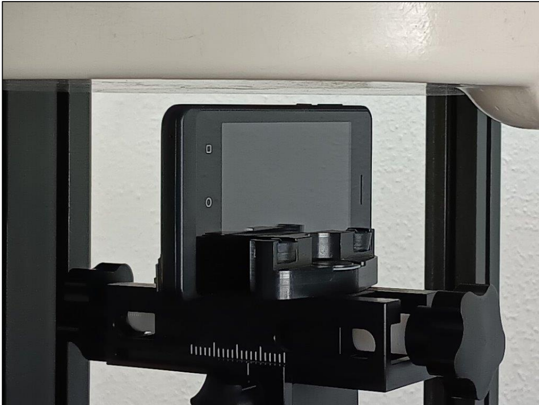
Photo 11: Position d'essai face du côté gauche contre le corps (distance 5 mm)
