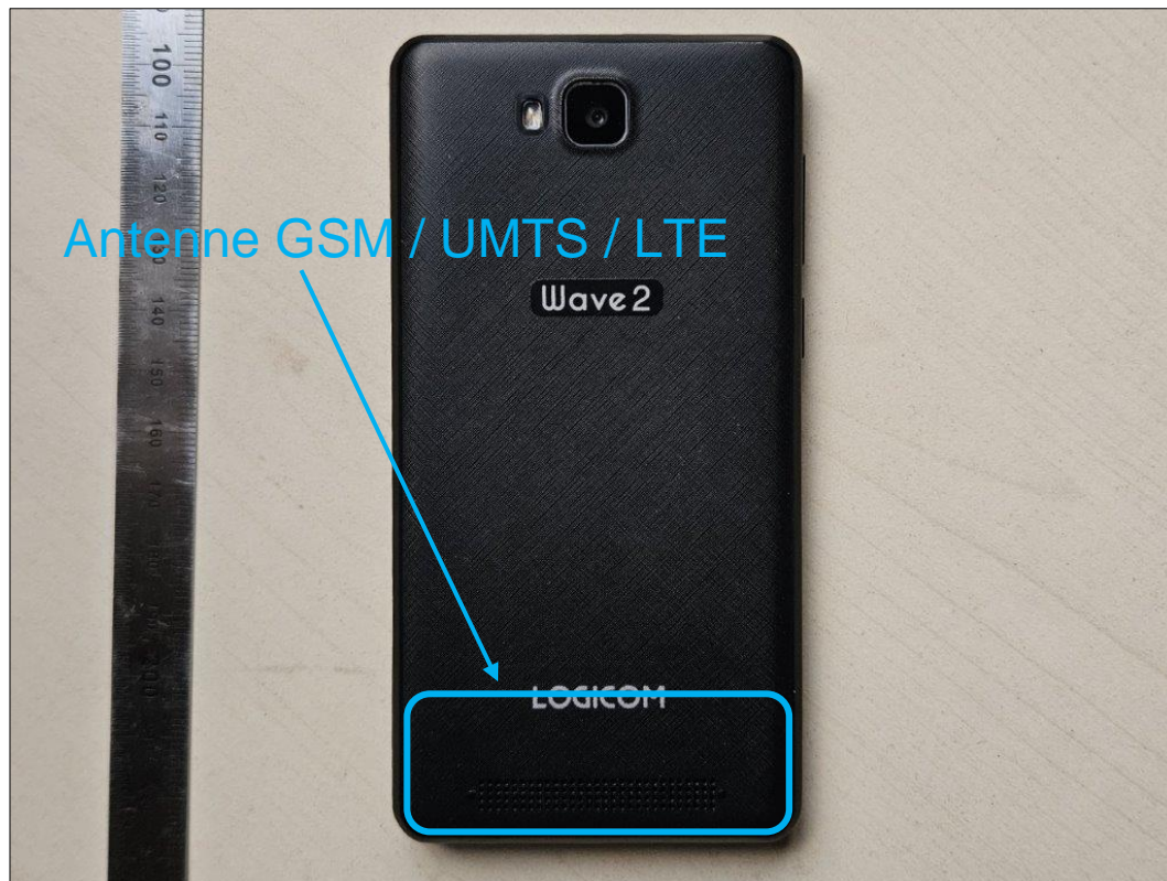
Photo 4: EST – vue arrière
