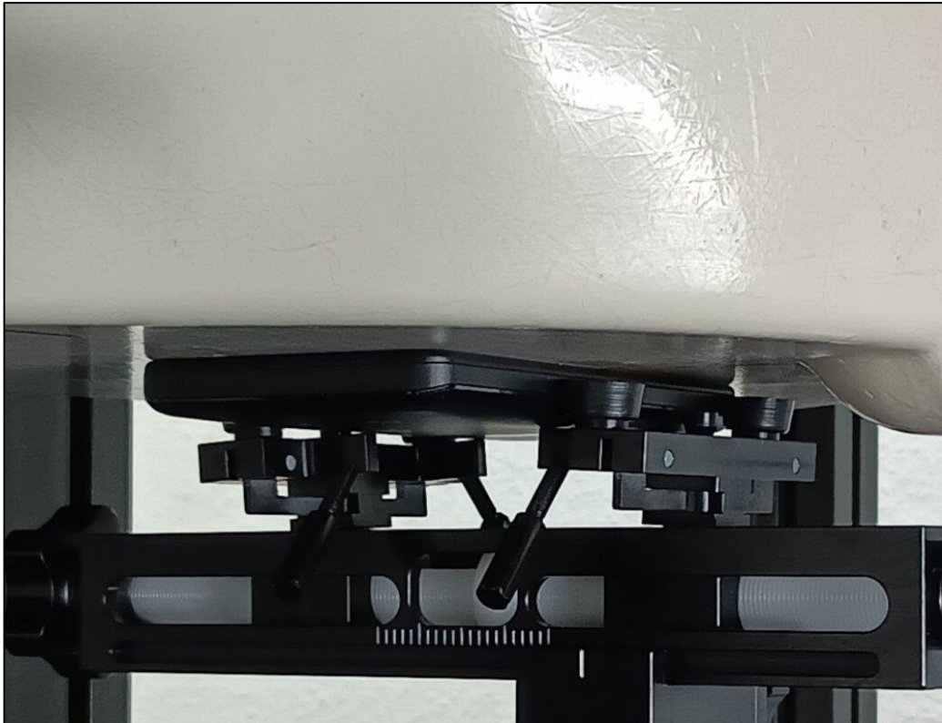
Photo 9: Position d'essai face avant contre le membre (distance 0 mm)
