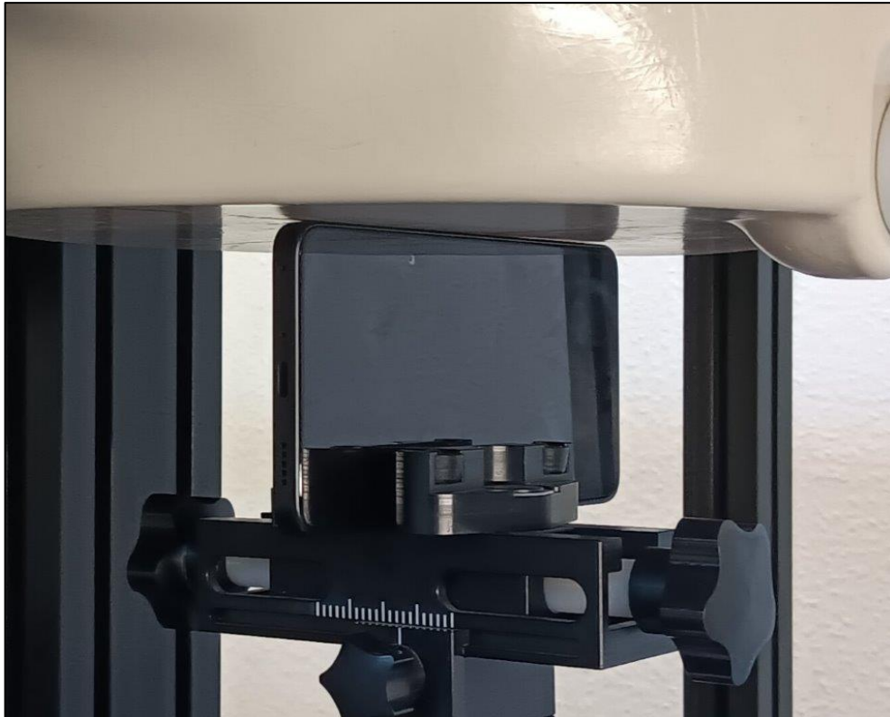
Photo 9: Position d'essai face du côté gauche contre le membre (distance 0 mm)
