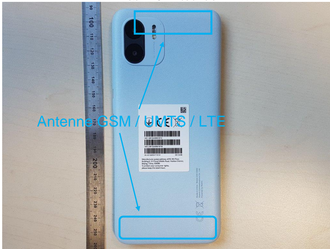
Photo 4: EST – vue arrière
