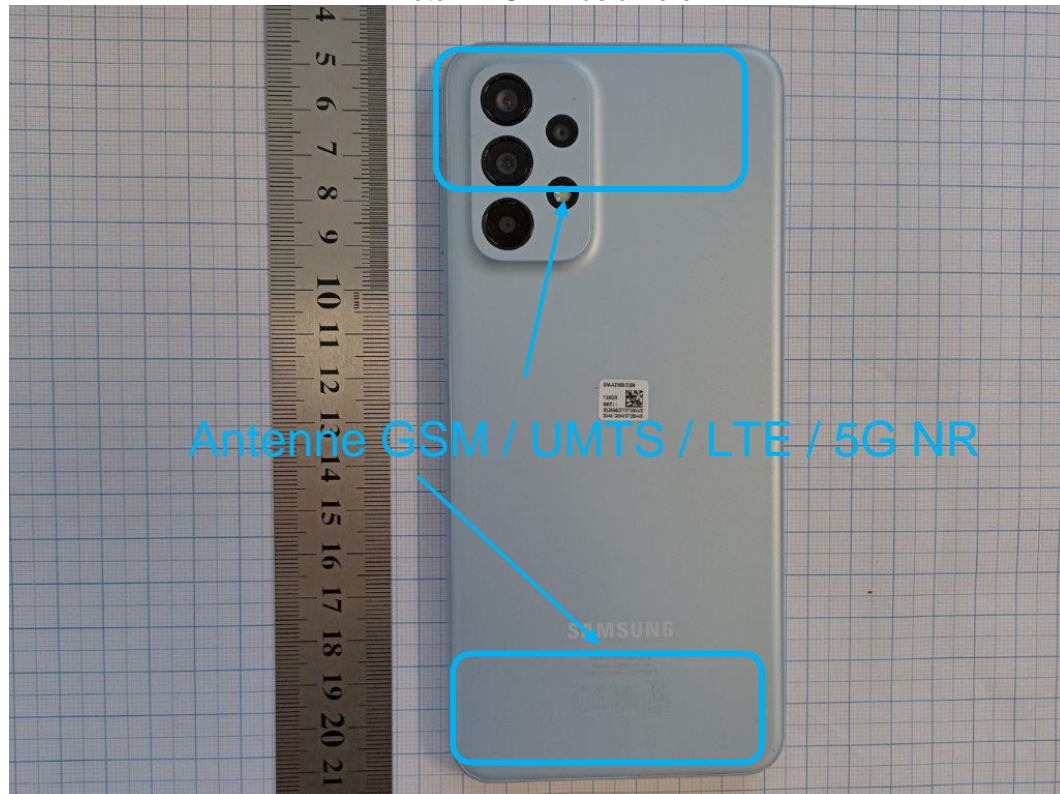
Photo 4: EST – vue arrière
