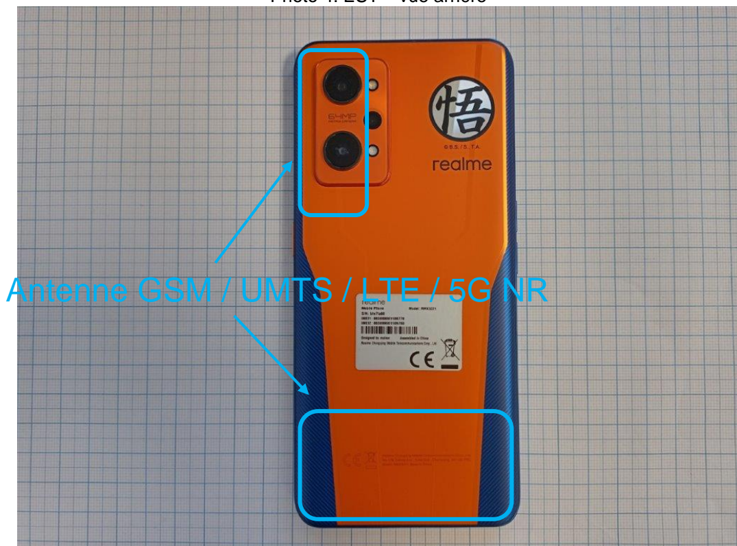
Photo 4: EST – vue arrière
