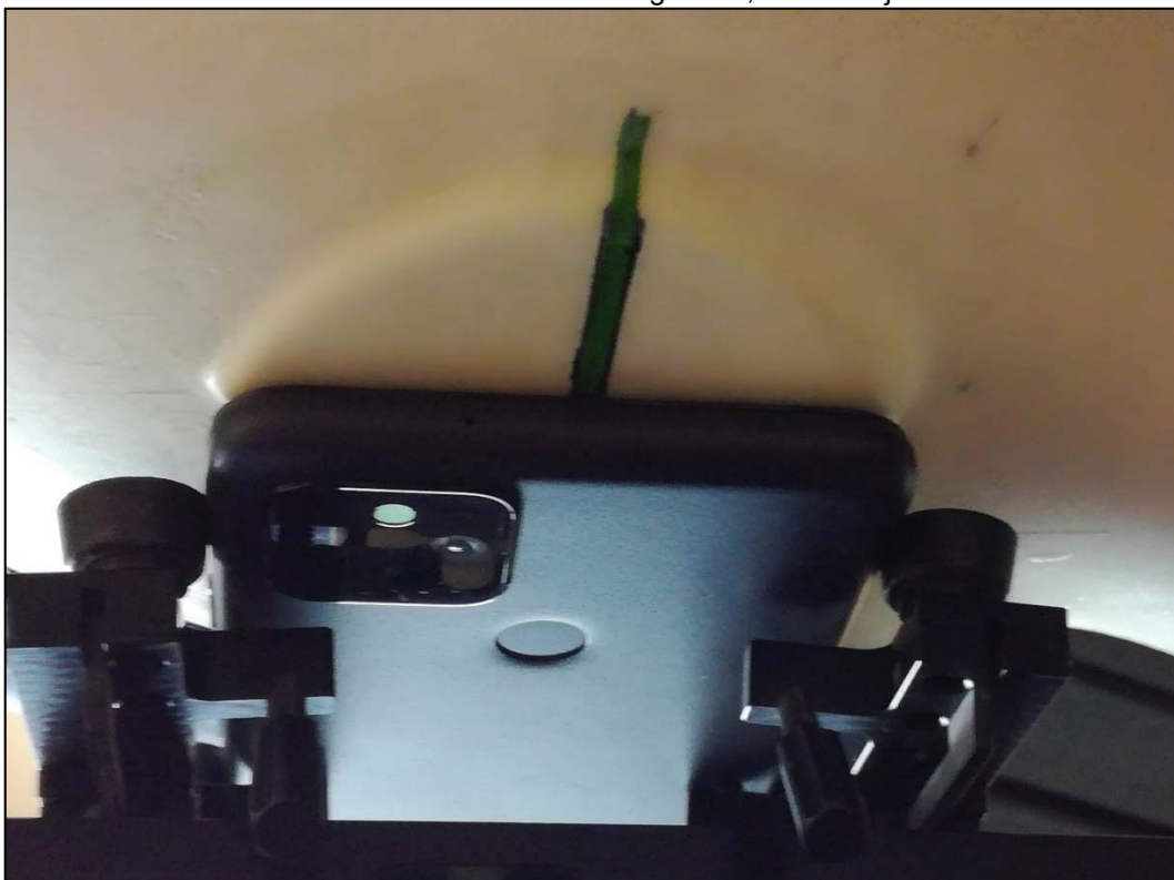
Photo 8: Position d'essai main gauche, contre la joue
