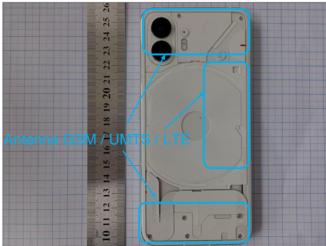
Photo 4: EST – vue arrière
