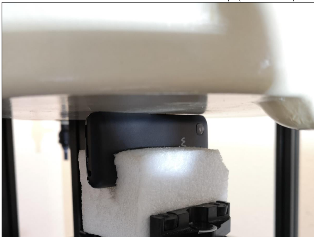
Photo 11: Position d'essai face du côté droite contre le corps (distance 0 mm)
