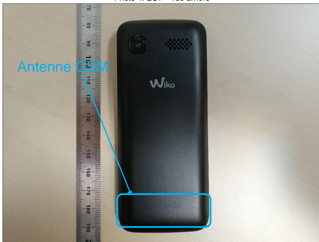
Photo 4: EST – vue arrière
