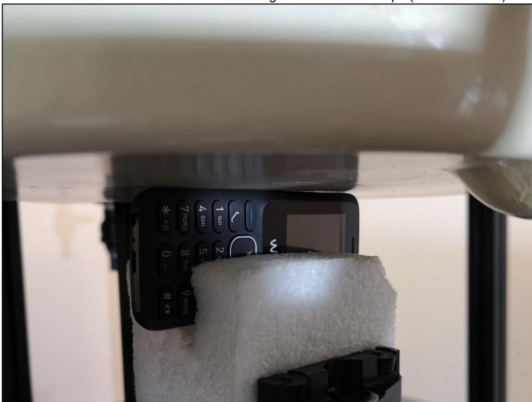
Photo 10: Position d'essai face du côté gauche contre le corps (distance 0 mm)
