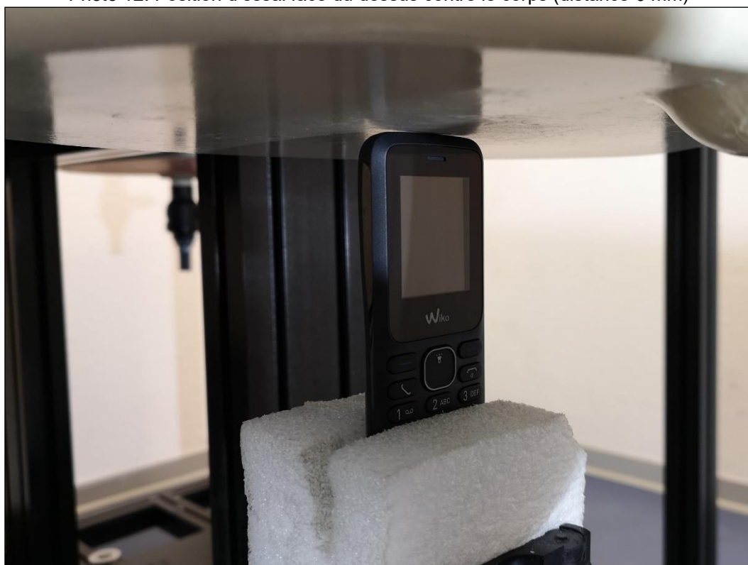
Photo 12: Position d'essai face du dessus contre le corps (distance 0 mm)
