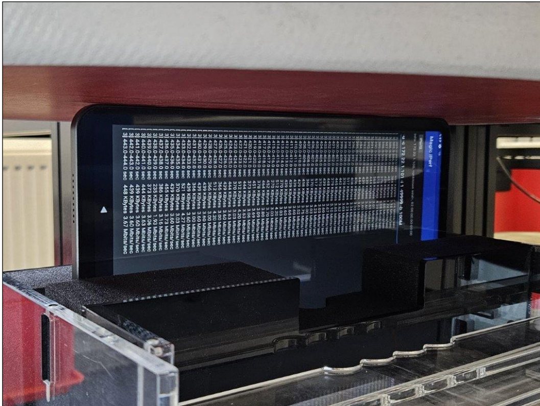
Photo 10: Position d'essai face du dessus contre le membre (distance 0 mm)
