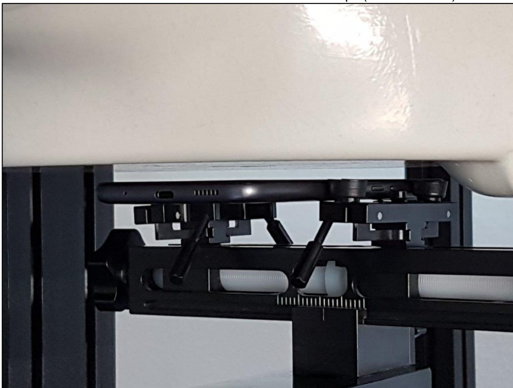
Photo 7: Position d'essai face avant contre le corps (distance 5 mm)
