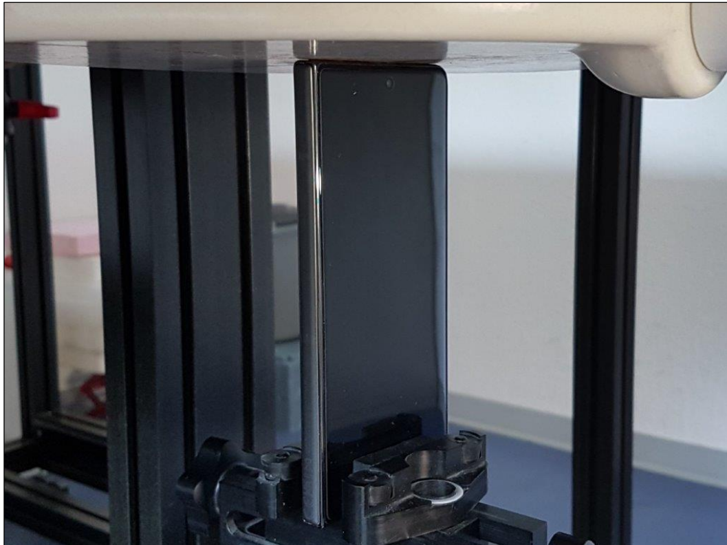
Photo 16: Position d'essai face du dessus plié contre le membre (distance 0 mm)
