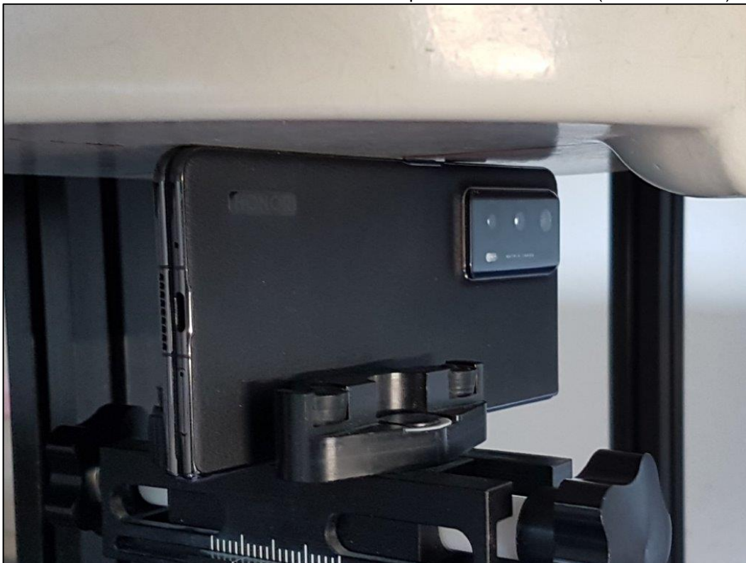
Photo 15: Position d'essai face du côté droite plié contre le membre (distance 0 mm)
