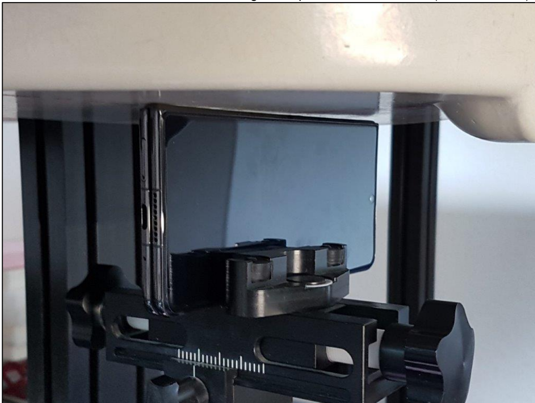
Photo 14: Position d'essai face du côté gauche plié contre le membre (distance 0 mm)
