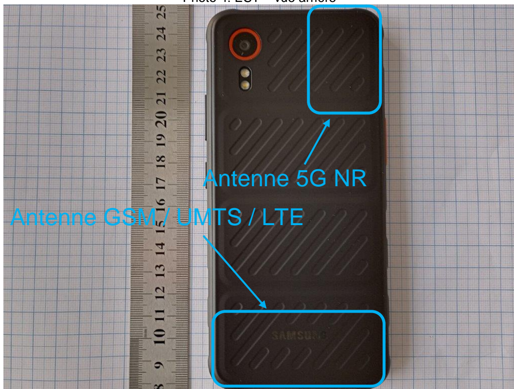
Photo 4: EST – vue arrière
