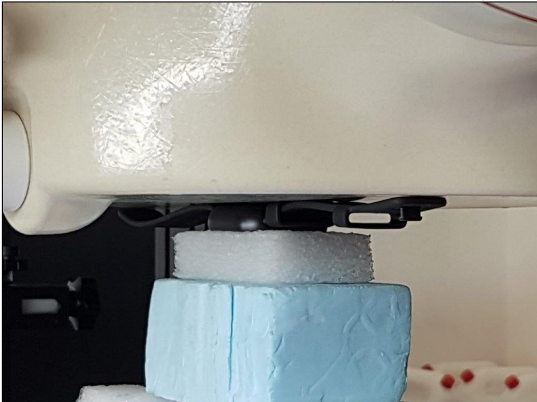
Photo 6: Position d'essai face arrière contre le membre (distance 0 mm)
