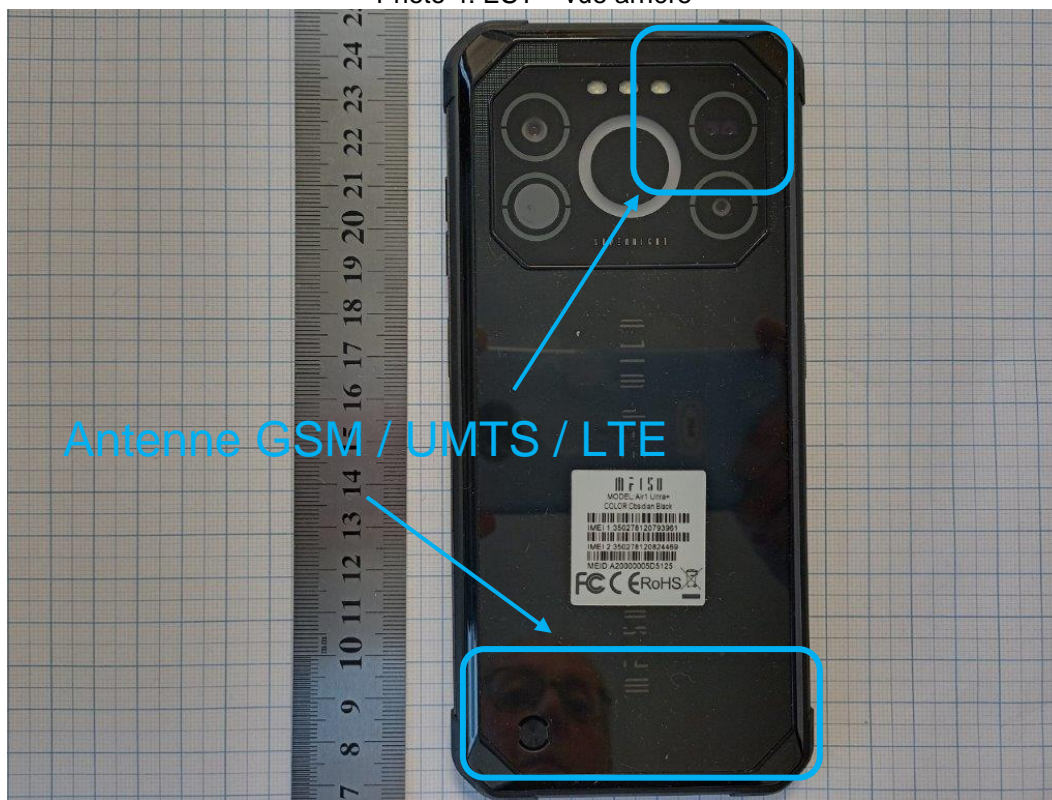
Photo 4: EST – vue arrière
