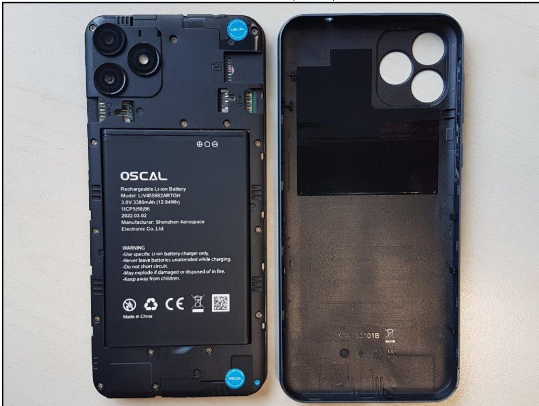
Photo 5: EST – vue arrière (ouvert) avec batterie
