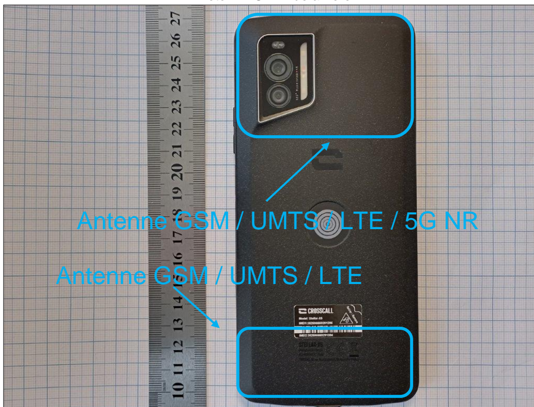
Photo 4: EST – vue arrière
