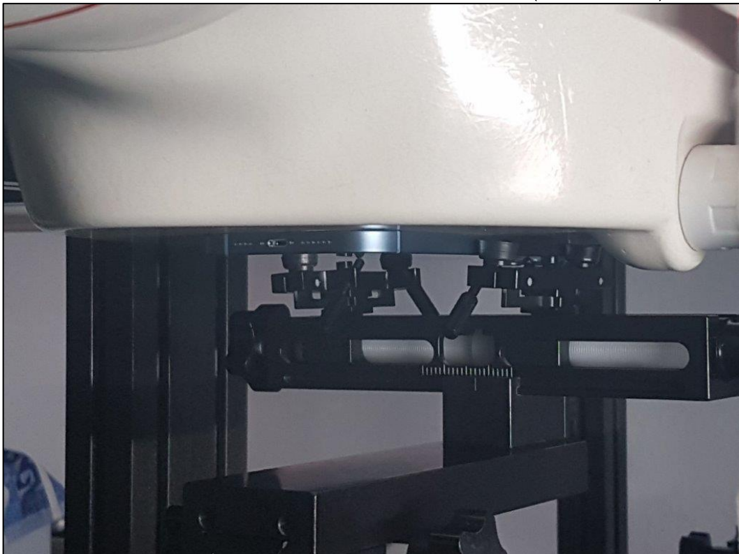
Photo 6: Position d'essai face avant contre le membre (distance 0 mm)
