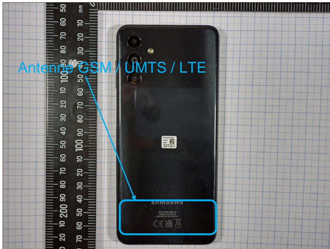
Photo 4: EST – vue arrière
