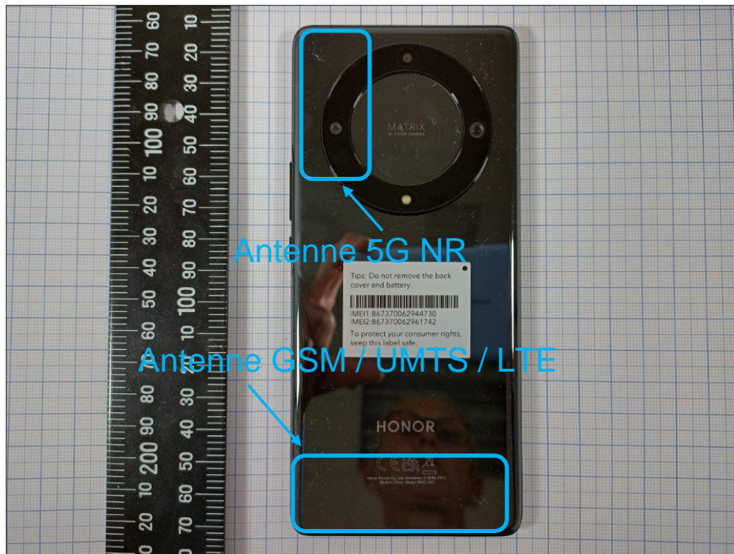
Photo 4: EST – vue arrière
